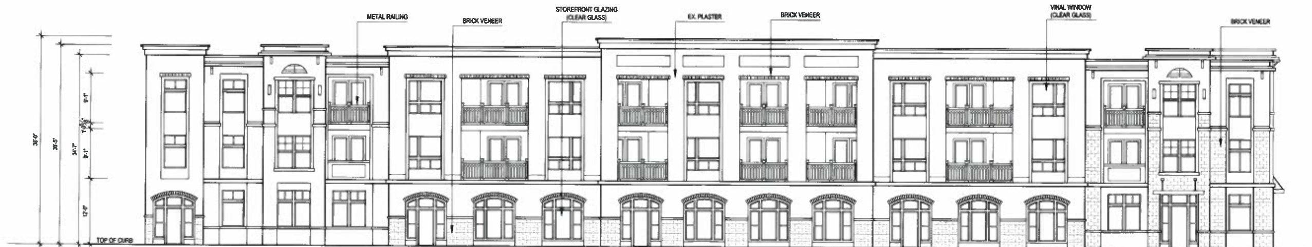
EAST ELEVATION (ALONG INDIANA AVE.) SCALE: 1/8" = 1'-0"
