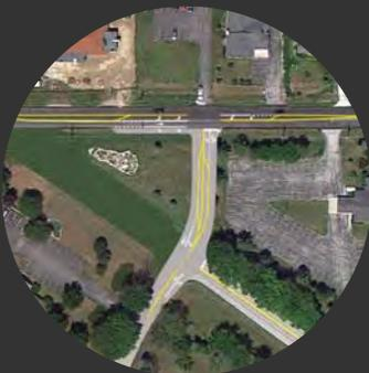
Modificación de intersecciones sesgadas mejora la seguridad peatonal y la accesibilidad por reconfigurar la intersección de la calle más cerca de 90 grados. Otros tratamientos incluyen agregar medianas o islas de canalización.
