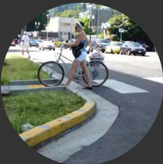
Ampliando la zona de banqueta en el carril de estacionamiento en la calle, extensiones de banqueta acortan la distancia a caminar por la calle, que sea más fácil para los conductores ver a los peatones y conductores retrasar al dar vuelta.
